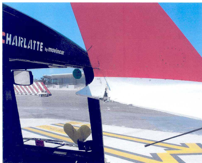
Urto tra un mezzo di rampa ed un aeromobile.
