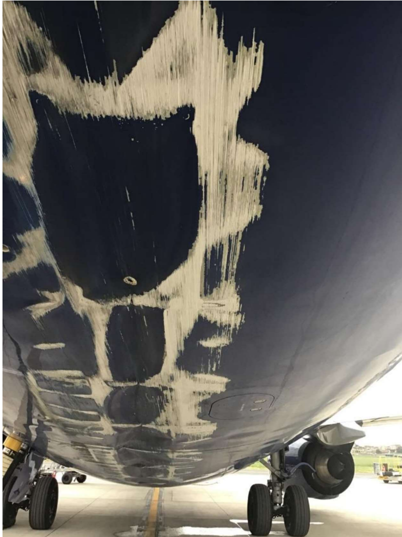
I danni nella parte posteriore della fusoliera del B737 marche YR-BMM.
