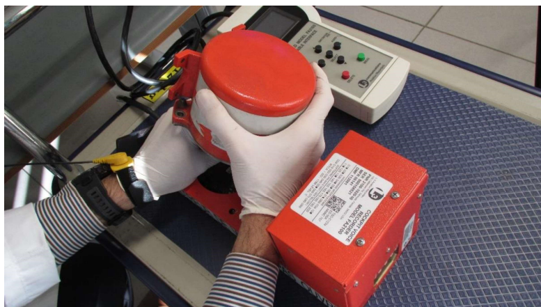
Attività di recupero dati dal recorder danneggiato che era installato a bordo dell'A109E marche VT-CHG. Nella foto, il trapianto della CSMU su replay unit ANSV opportunamente configurata.
