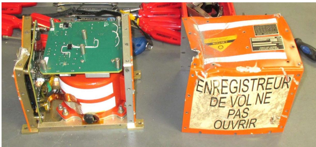
Attività di recupero dati dal recorder danneggiato che era installato sul velivolo FA346 CSX55268. Nella foto, il recorder dopo la fase di apertura.
