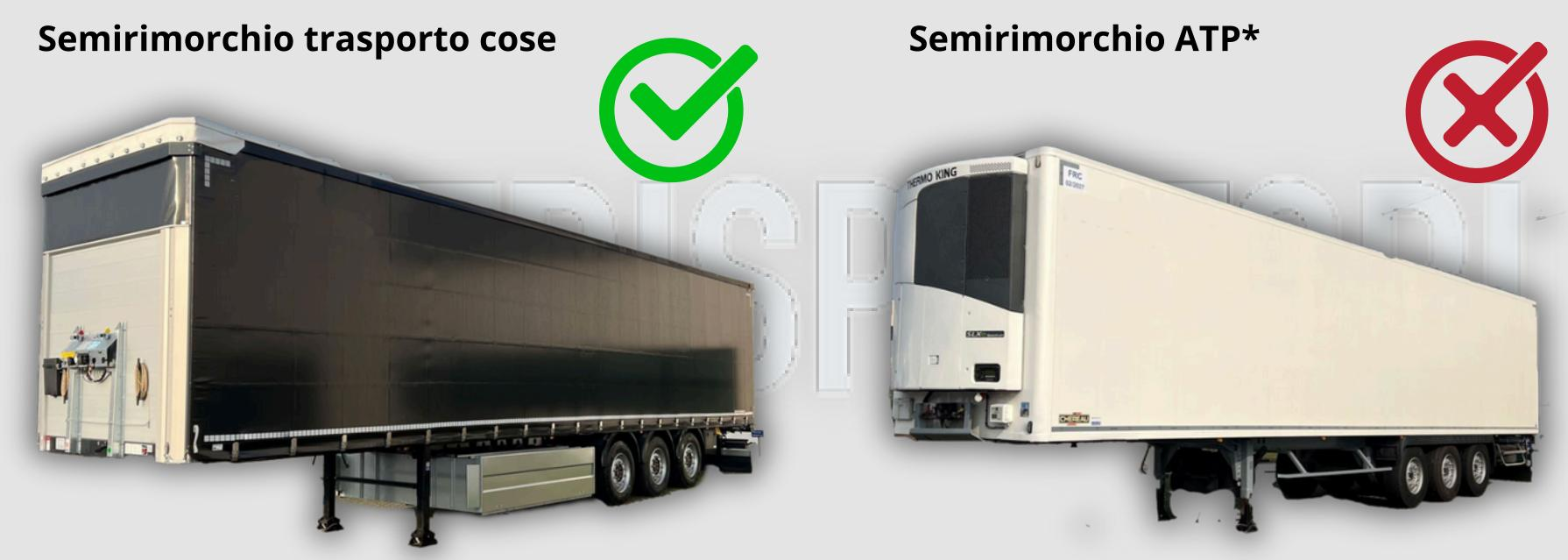
L'ATP è una documentazione obbligatoria per i veicoli isotermici adibiti al trasporto di cose che certifica il corretto funzionamento dell'unità coibentata. La verifica supplementare durante la revisione consiste nel controllo della data di scadenza presente sul documento cartaceo.
