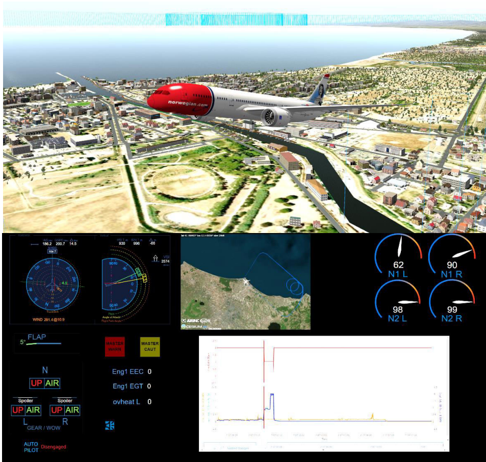
Esempio di rappresentazione grafica 3D realizzata nei laboratori ANSV a partire dai dati FDR.
