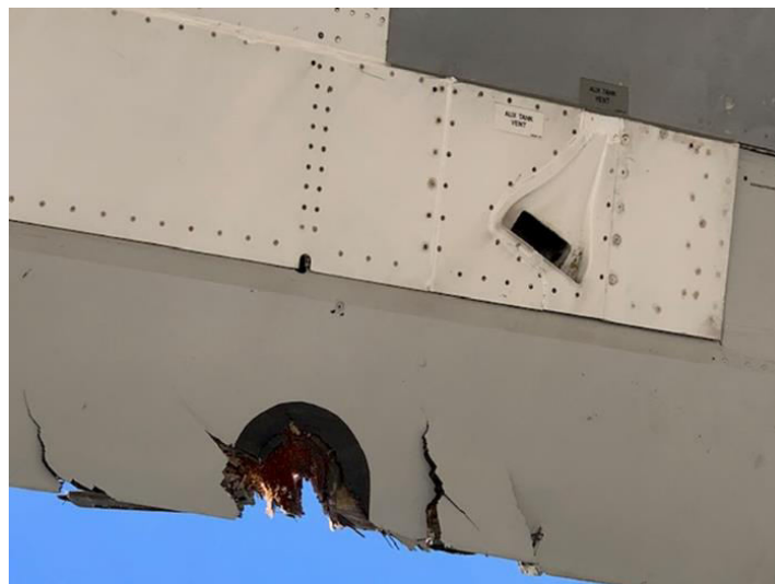
Danno provocato al B767 marche SE-RLC dall'urto durante le operazioni di push back contro una torre faro mobile.
