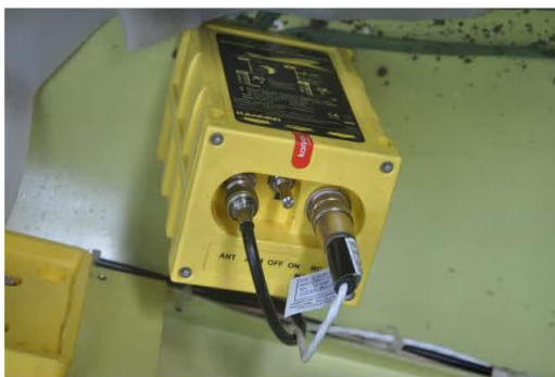
Foto di un apparato ELT, così come rinvenuto nel corso di un sopralluogo a seguito di un incidente.
