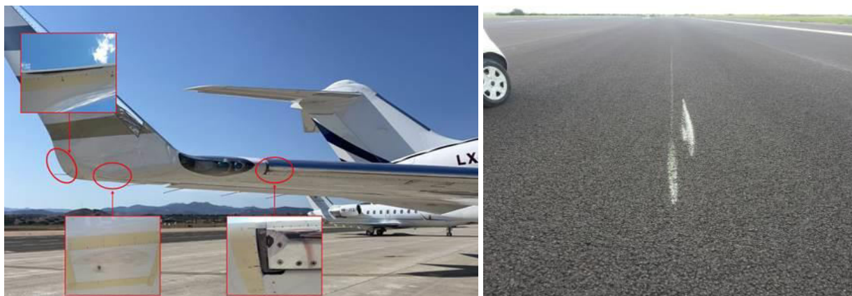
Vista della semiala destra del Global 5000 marche LX-ABM con i dettagli dei danni riportati (foto a sinistra); segni rilevati sulla pista dell'aeroporto di Brescia Montichiari (foto a destra).
